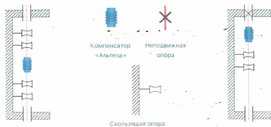
Схема расположения скользящих опор вблизи компенсатора ДУ 15 - 40 мм
